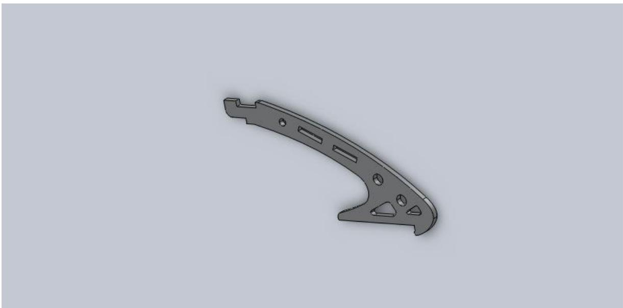
In dieses Seitenteil stecken wir eine der beiden Querstreben dafür, achten Sie bitte auf die korrekte Ausrichtung dieses Bauteils ( gerade Kante nach aussen – unten ) , warum das so ist merken Sie spätestens, wenn das Monocoque mit den Auslegern verbunden wird.
