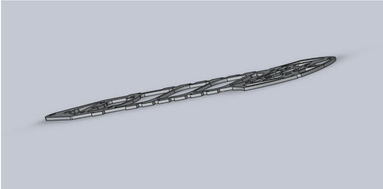
Hauptbauteil des Auslegers ist die Auslegergrundplatte an die alle anderen Teile angesteckt werden. Nehmen Sie jetzt ein Seitenteil des Auslegers und verbinden Sie dieses über die Steckverbindungen mit der Auslegergrundplatte. ( das soll und muss sehr streng gehen, mit etwas Kraft, Fingerspitzengefühl und einer kleinen Spitzzange, deren Enden mit Isolierband umwickelt sind, geht das sehr gut )
