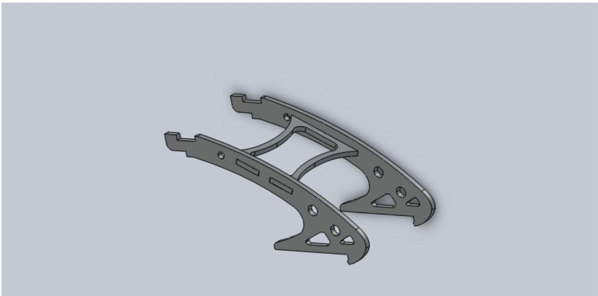
Sicher ist Ihnen aufgefallen, dass da eine ganz anders aussehende Querstrebe dabei ist, genau diese ist für die hintere Seinteilkombination, denn an diesen Querstreben lässt sich Ihr Empfänger mittels eines Klettbandes sehr gut an der Innenseite zum Monocoque anbringen.
