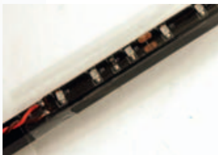
LED-Beleuchtung mit Schrumpfschlauch
