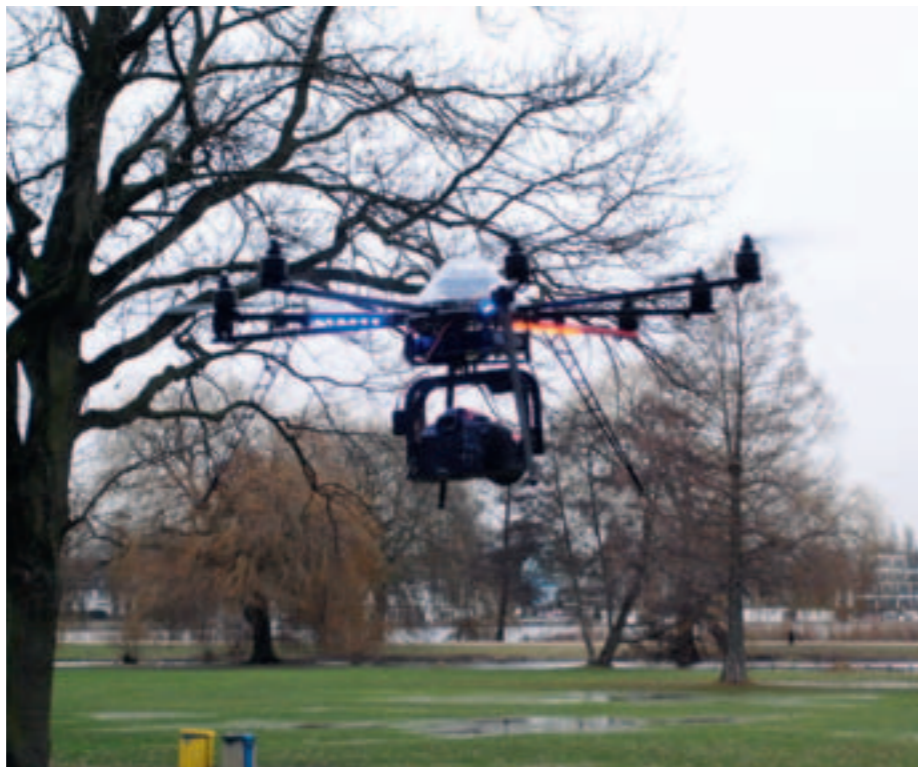
Die LED-Beleuchtung vereinfacht die Positionsbestimmung des Modells auch bei schlechtem Wetter
