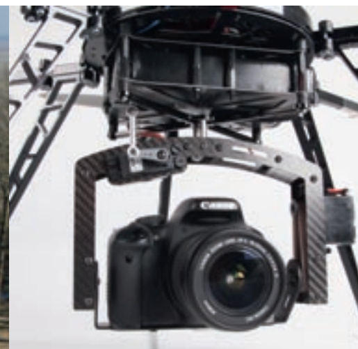
Die Kamerahalterung wird von handelsüblichen Servos automatisch in die gewünschte Richtung gesteuert
