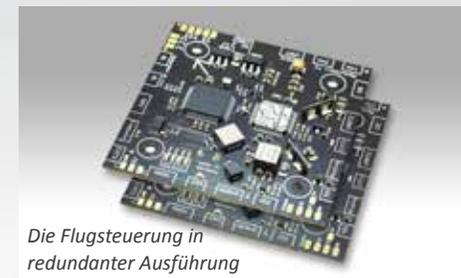
Die Flugsteuerung in redundanter Ausführung
